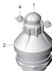
Posizionare il sigillo di taratura legando il con filo metallico (4) il tappo (1) e la campana di regolazione (2), applicando infine la piombatura
