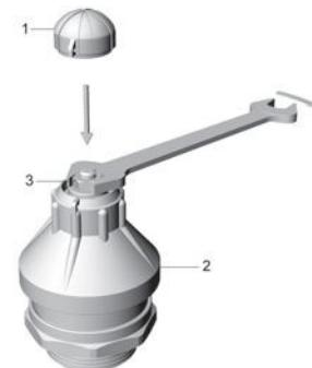
A regolazione completata, riavvitare il controdado di arresto (3) tenendo ferma la campana di regolazione (2). Il controdado deve essere avvitato con una coppia di serraggio di 10 Nm (min).
