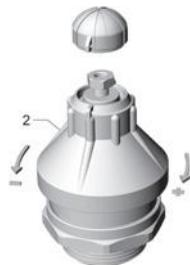
Regolare la pressione sulla molla, ruotando la campana di regolazione (2). Ruotare in senso orario per aumentare la pressione, ruotare in senso antiorario per diminuirla. Durante tale operazione non è necessario mantenere ferma l'asta con il cacciavite, in quanto la spinta della molla è sufficiente a non fare ruotare l'asta stessa
